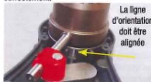
Le remontage est l'inverse du démontage. Le roulement du rotateur (8) doit être à gauche de l'arbre de transmission ayant le mot "TOP" inscrit sur le haut.
