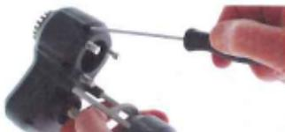
Step 2. En vous servant du tournevis hexagonal inclus dans la trousse dévisser les six vis (11) de dessus et de dessous le boîtier
